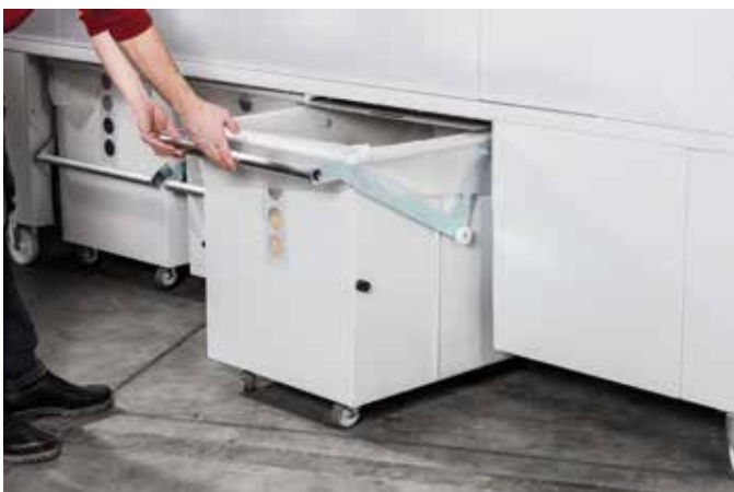
Spänebehälter wieder einsetzen und Staubschott entfernen
