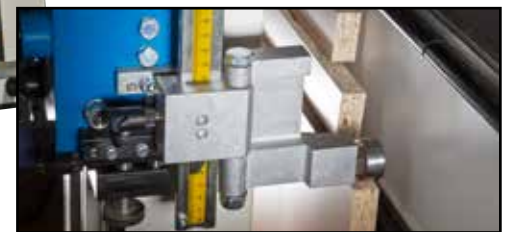
Optionale Streifenanschlätze erleichtern die exakte Reproduktion von waagerechten Schnitten.
