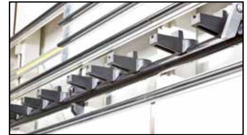
Ausklappbare Mittenauflagen für Platten mit geringer Höhe sind standardmäßiger Bestandteil aller Putsch ® Plattensägen.
