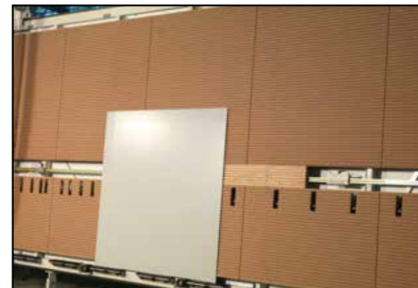
Grundrahmen mit vollflächiger Arbeitsplatte aus MDF.
