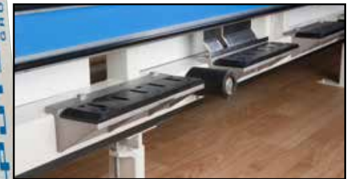
Die stabilen Plattenablagen werden durch einschwenkbare Transportrollen zum einfachen Plattentransport ergänzt.
