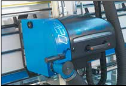
Die Schleppkette am Sägewagen führt und schützt alle Kabelverbindungen effektiv.
